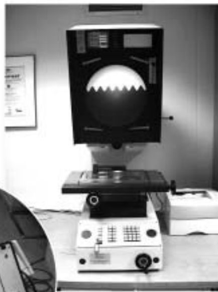
Profilprojektor zur Messung von Konturen
