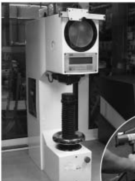
Härtemessgerät zur Prüfung der Härten nach Vickers, Rockwell und Brinell
